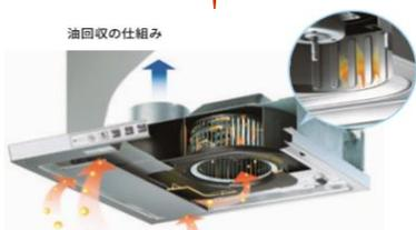
シロッコファンとオイルストッパーで油を捕集させるノンフィルタタイプ。回転による遠心力で、油をベルマウスー一体型オイルトレイに滴下させます。お掃除が面倒なフィルタがなく、インナーガードも採用し、レンジフード内部の汚れを防ぎます。目詰まりなしで吸引力の低下なし！
